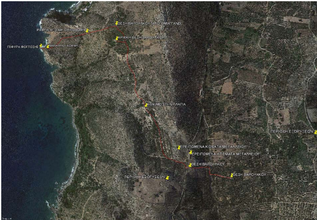
Εικ. 8. Χάρτης του βιομηχανικού σιδηροδρόμου μεταλλευτικού πεδίου Ραβδούχας. Η σιδηροδρομική γραμμή υπομνηματίζεται με ερυθρό χρώμα και τα τεχνικά έργα σημειώνονται με κίτρινο χρώμα. Χαρτογραφικό υπόβαθρο © google.earth .
