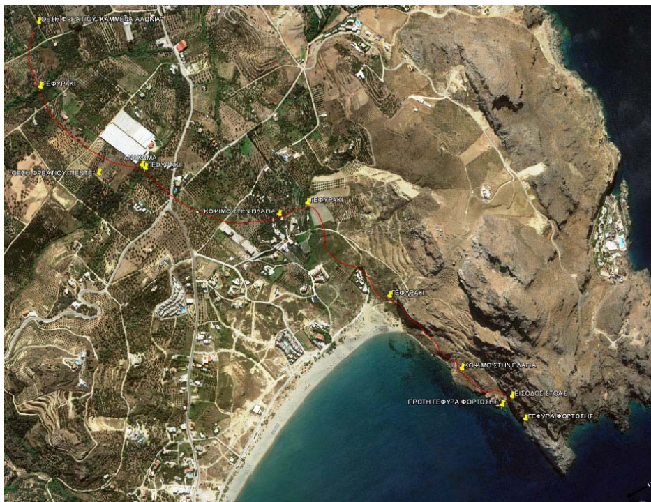
Εικ. 5. Χάρτης του βιομηχανικού σιδηροδρόμου Πλακιά. Η σιδηροδρομική γραμμή υπομνηματίζεται με ερυθρό χρώμα και τα τεχνικά έργα σημειώνονται με κίτρινο χρώμα. Χαρτογραφικό υπόβαθρο © google.earth .
